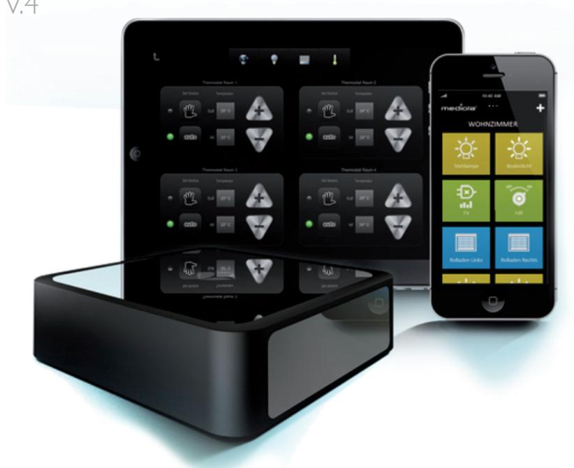
Das mediola<sup>®</sup> AIO GATEWAY ist ein kleiner intelligenter IP-Konverter, der alle Geräte, die normalerweise nur mit konventionellen Infrarot- & Funk-Fernbedienungen steuerbar sind, „APP-fähig“ macht. Dadurch lassen sich TV, Hifi, Licht, Rollläden, Jalousien u. v. m. bequem und von überall mittels iPad, iPhone, Android & Co steuern, mit dem Internet verbinden und jede Wohn- und Büroumgebung in ein Smart Home/ Smart Office verwandeln.
