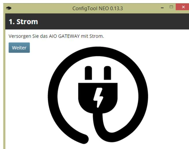
Nun schließt man das Gateway an den Strom an. Ist das AIO Gateway V5 schließlich mit dem Strom verbunden, klickt man auf "Weiter".
