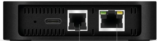
mediola compactIP (RJ12) LAN Ethernet (RJ45)
